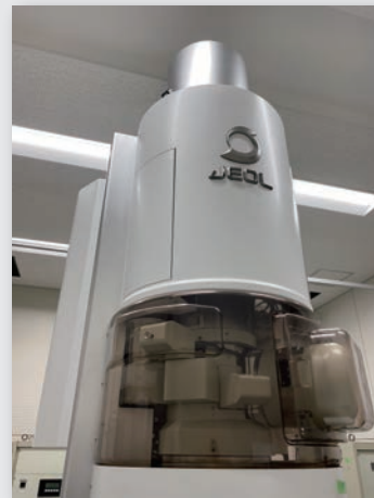
原子分解能分析電子顕微鏡(JEM-ARM200F NEOARM)
